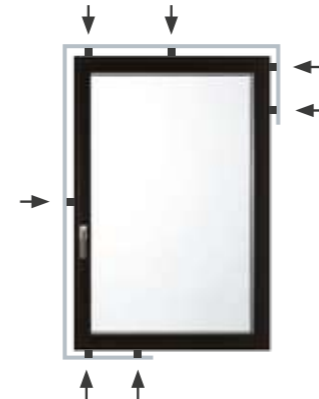
VERROUILLAGE MULTIPONTS CHAINAGE DES ÉLÉMENTS AVEC RENVOI D'ANGLE EN PARTIE HORIZONTALE. MEILLEUR MAINTIEN DU VANTAIL. OPTIMISE LA SÉCURITÉ DE LA MENUISERIE AMÉLIORE LA COMPRESSION
